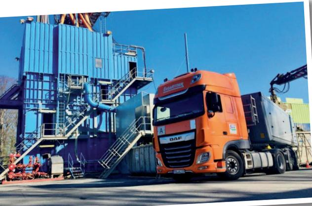
Die unterschiedlichen Schlamm-Konsistenzen, die bei Geothermie-Erdbohrungen entstehen, bereitet Ehgartner auf, dehydriert sie und entsorgt sie mit Spezial-Fahrzeugen. Infos zu Geothermie-Erdbohrungen gibt's hier: [www.geothermie.de](http://www.geothermie.de)
