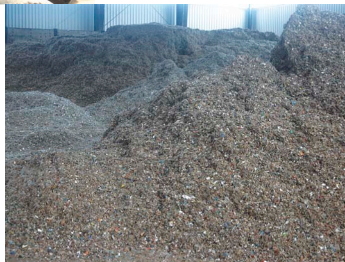
In einer 1800 Quadratmeter großen Halle lagern die Ersatzbrennstoffe, die unter anderem in der Zementindustrie verwendet werden.
