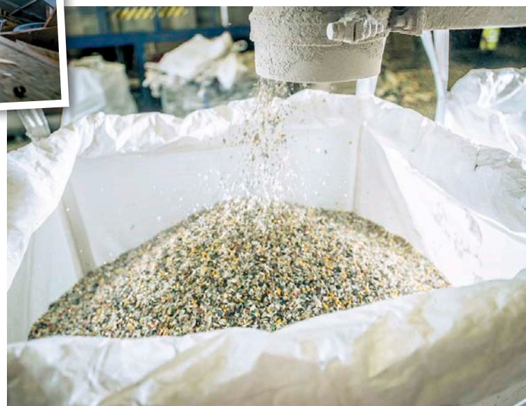
In „Big Bags“ werden die zermahlenen Kunststoffe zum Kunden transportiert und finden Wiederverwendung in hochwertigen Produkten.
